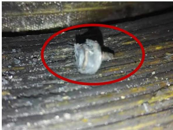
高压线圈发现金属螺丝
