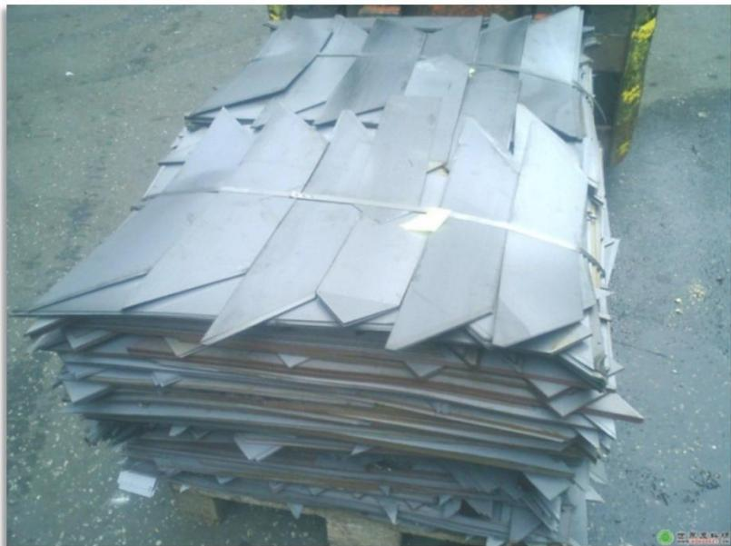
从变压器上拆除的硅钢片
